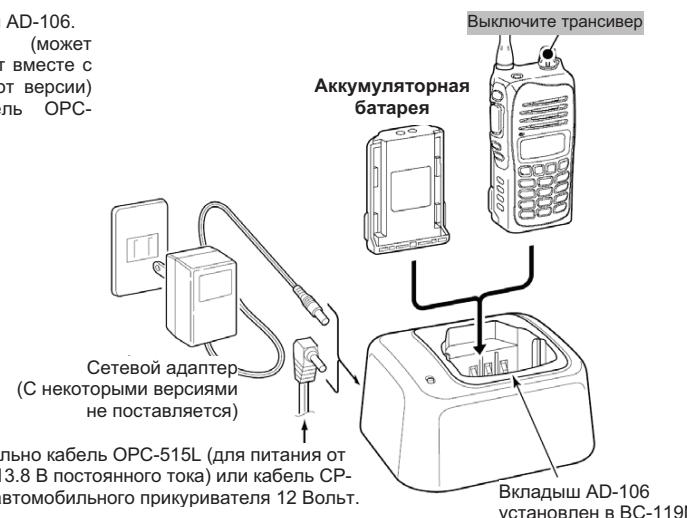
Приобретаемый отдельно кабель OPC-515L (для питания от внешнего источника 13.8 В постоянного тока) или кабель CP-17L (для питания от автомобильного прикуривателя 12 Вольт).
