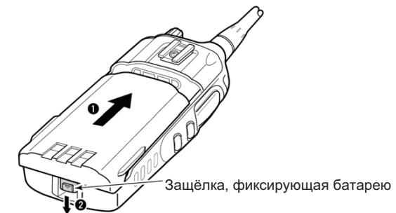
Защёлка, фиксирующая батарею
