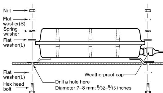
**ПРЕДУПРЕЖДЕНИЕ:** Надежно закрепить АТ-140 посредством поставляемых гаек и болтов. В противном случае, вибрации и удары, обусловленные морскими волнами и другими факторами, могут ослабить крепление и привести к падению тюнера, создавая угрозу нанесения травм.
