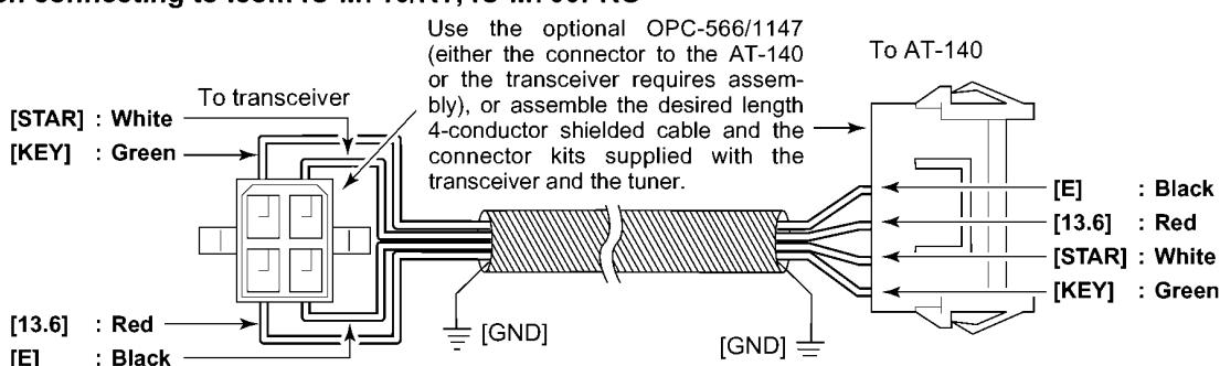
для AT-140, либо потребуется установить его на трансивер) или установить на 4-жильный экранированный кабель желаемой длины разъем из комплекта, поставляемого с трансивером и тюнером.
