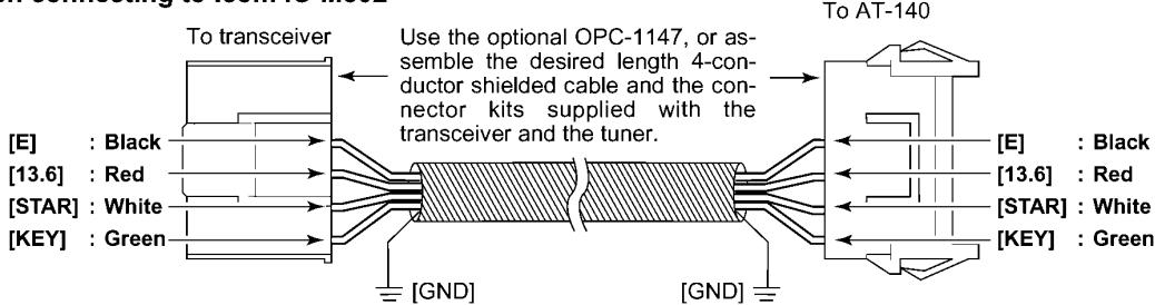
жильный экранированный кабель желаемой длины и комплект разъемов, поставляемого с трансивером и тюнером.
