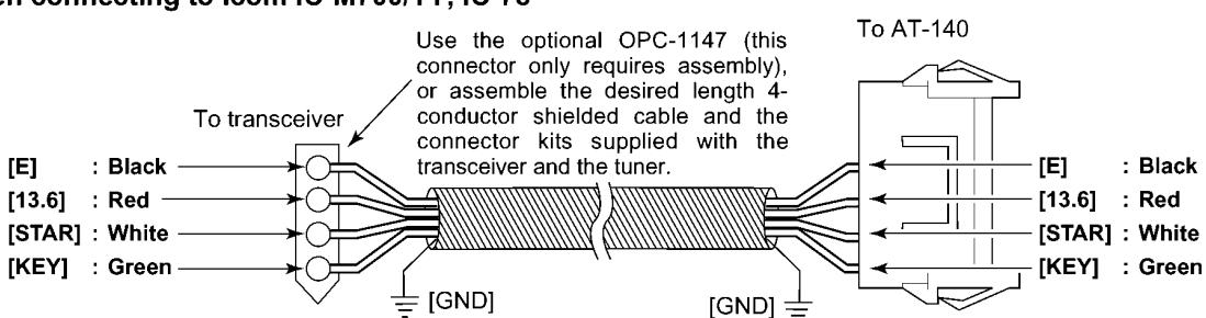
Использовать доступный по отдельному заказу кабель OPC-1147 (достаточно установить разъем) или установить на 4-жильный экранированный кабель желаемой длины разъем из комплекта, поставляемого с трансивером и тюнером.
