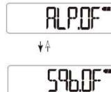
Активирование или деактивирование функции автоматического понижения мощности.
