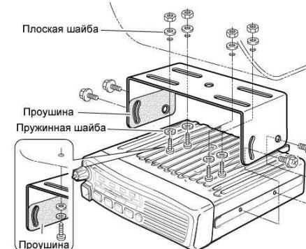
Проушина позволяет снизить воздействия вибрации.
