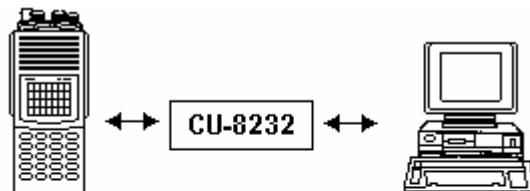
Компьютерное управление с использованием приобретаемого дополнительно интерфейса CU-8232 плюс провода и программное обеспечение
