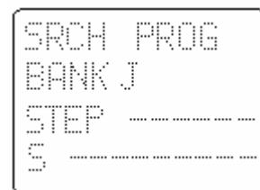
Выберите банк программного поиска "J" вводом с клавиатуры [**0J**] или с использованием клавиш UP/DOWN или поворотом [**DIAL**]. При отображении "J" нажмите [**ENT**] для выбора банка "J" для программирования. Верхняя строка LCD будет попеременно мигать между "SRCH PROG" и "BNK-J", что указывает на активизацию программирования.
