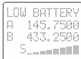
Индикация "LOW BATTERY" появляется, когда напряжение батарей снижается примерно до 4.5 В и индикация "BATT ERR" появляется при напряжении на батареях примерно 3.75 В. Конечно, эти уровни приблизительны и могут изменяться от приемника к приемнику.
