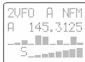
**Примечание:** на индикаторе частотного диапазона возможно появление уровней ложных сигналов, что связано с наличием местных шумов или близостью компьютерных систем.
