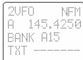
Дисплей вернется в режим VFO с высвечиванием прежней частоты и поиск не будет продолжен. Для возобновления программного поиска от прежней частоты нажмите **[SRCH]**. Если активная частота препятствует продолжению процесса поиска, используйте клавиши UP/DOWN для возобновления поиска в прежнем направлении.
