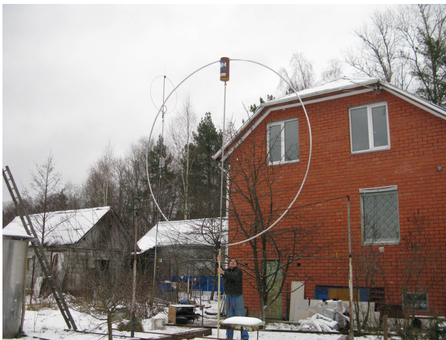
На фото антенна ML-4, с диаметром излучателя 4 метра.
