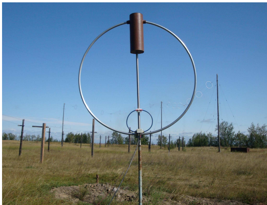
На фото антенна ML-1.7, с диаметром излучателя 1,7 метра.
